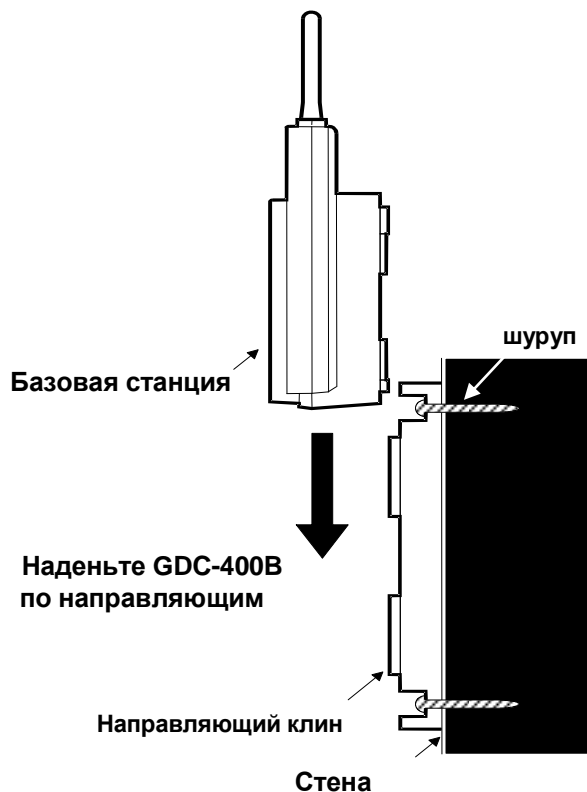
Рис. 6.4-2 Установка GDC-400B с использованием клинообразного основания – вид сбоку
